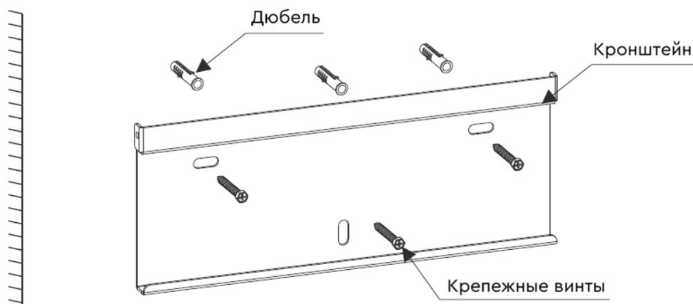
Рисунок 8. Монтаж кронштейна на стене.
