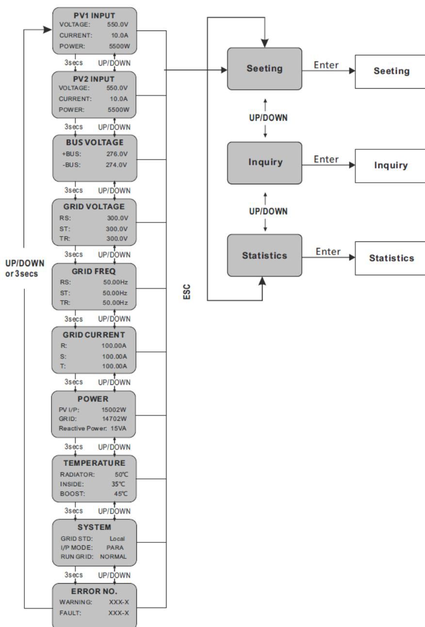
Рисунок 27. Интерфейс инвертора в циклическом режиме.
