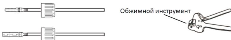
Рисунок 14. Обжим контактного штыря и кабеля.
