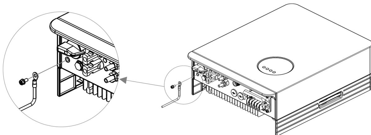
Рисунок 22. Подключение провода внешнего заземления.
