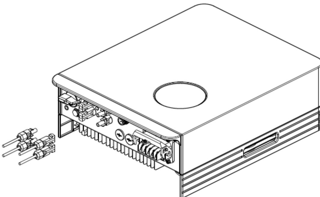
Рисунок 16. Подключение коннекторов с кабелем постоянного тока к инвертору.
