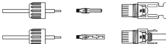
Рисунок 12. Отсоединение торцевой гайки коннектора.
