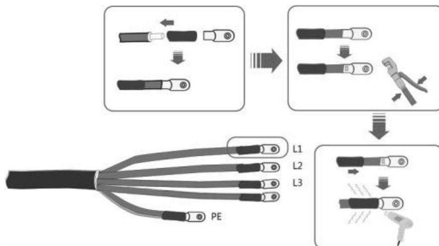
Рисунок 18. Обжим проводов.
