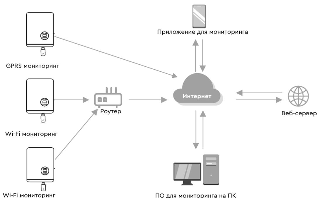
Рисунок 23. Схема системы мониторинга.
