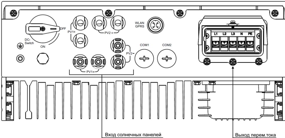
Рисунок 3. SMARTWATT GRID G2 25K 3P 2MPPT, вид снизу.
