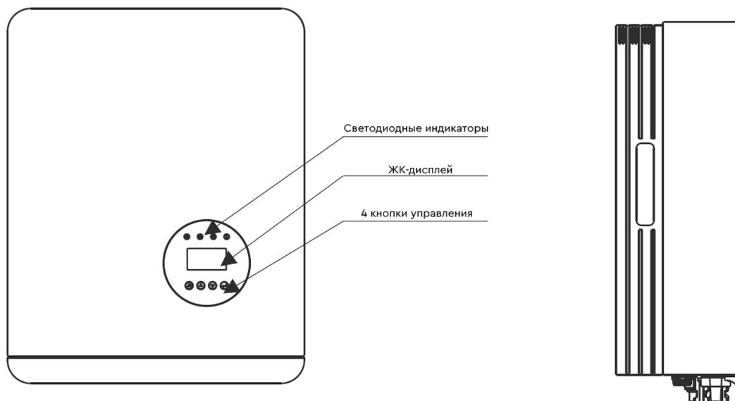
Рисунок 1. SMARTWATT GRID G2 15K 3P 2MPPT и SMARTWATT GRID G2 25K 3P 2MPPT, вид спереди.
