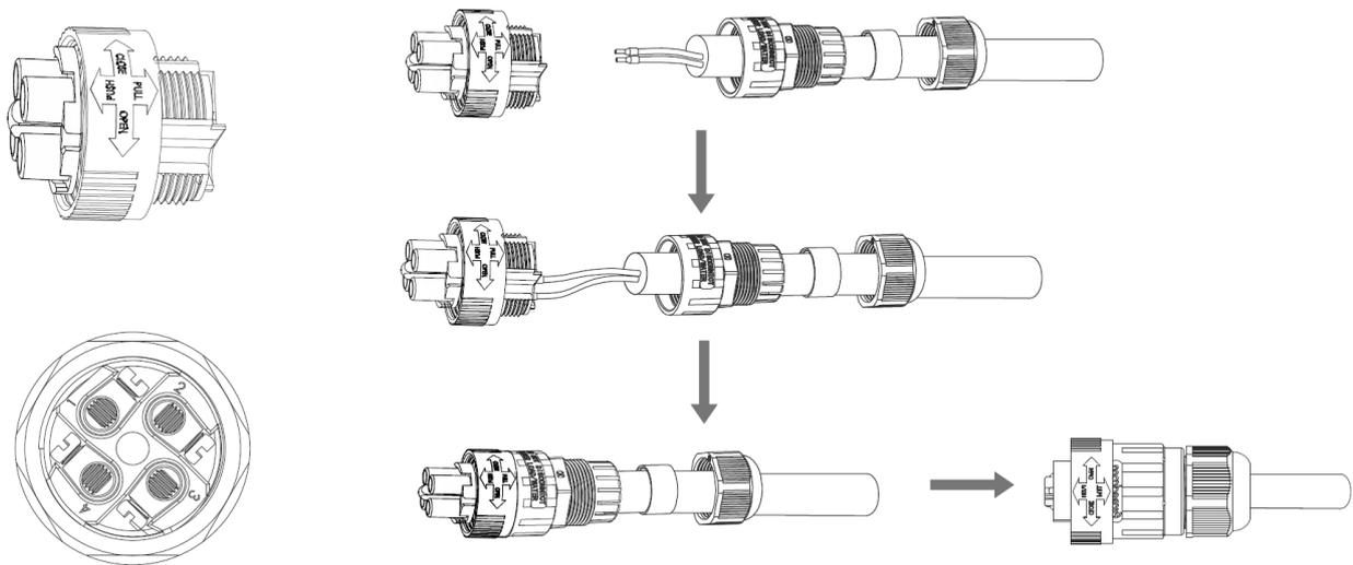
Рисунок 29. Сборка коннектора измерительного трансформатора тока.
