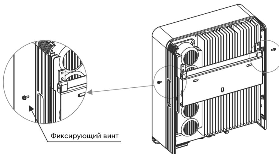
Рисунок 9. Кронштейн для крепления на стене.
