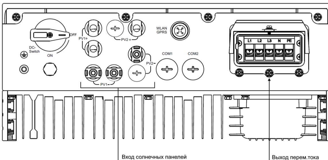
Рисунок 2. SMARTWATT GRID G2 15K 3P 2MPPT, вид снизу.
