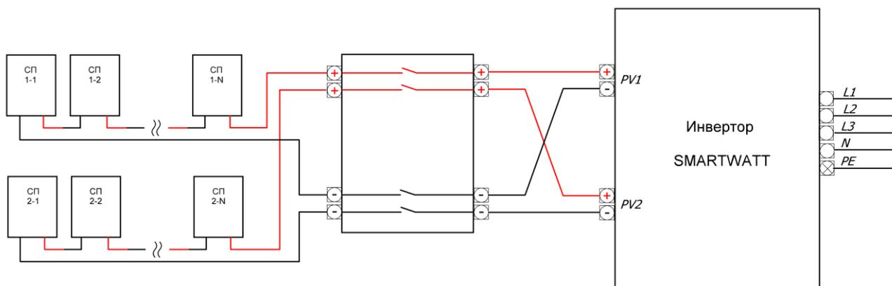
Рисунок 25. Режим независимого подключения.
