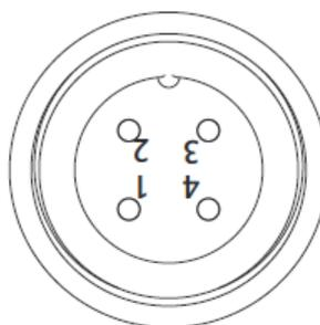
Рисунок 24. Порт WLAN/GPRS.
