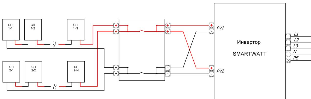
Рисунок 26. Режим параллельного подключения.
