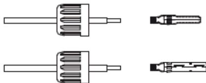
Рисунок 13. Соединение кабеля, торцевой гайки и контактного штыря.
