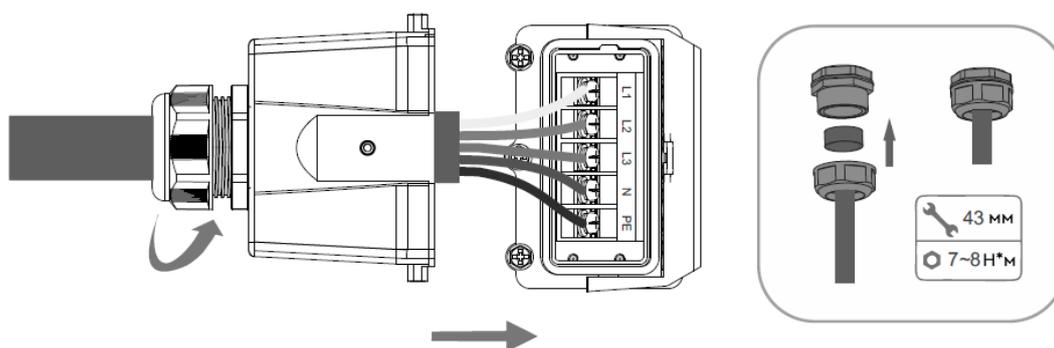
Рисунок 19. Подключение проводов.
