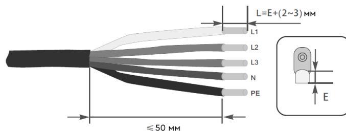
Рисунок 17. Обжим проводов наконечниками.
