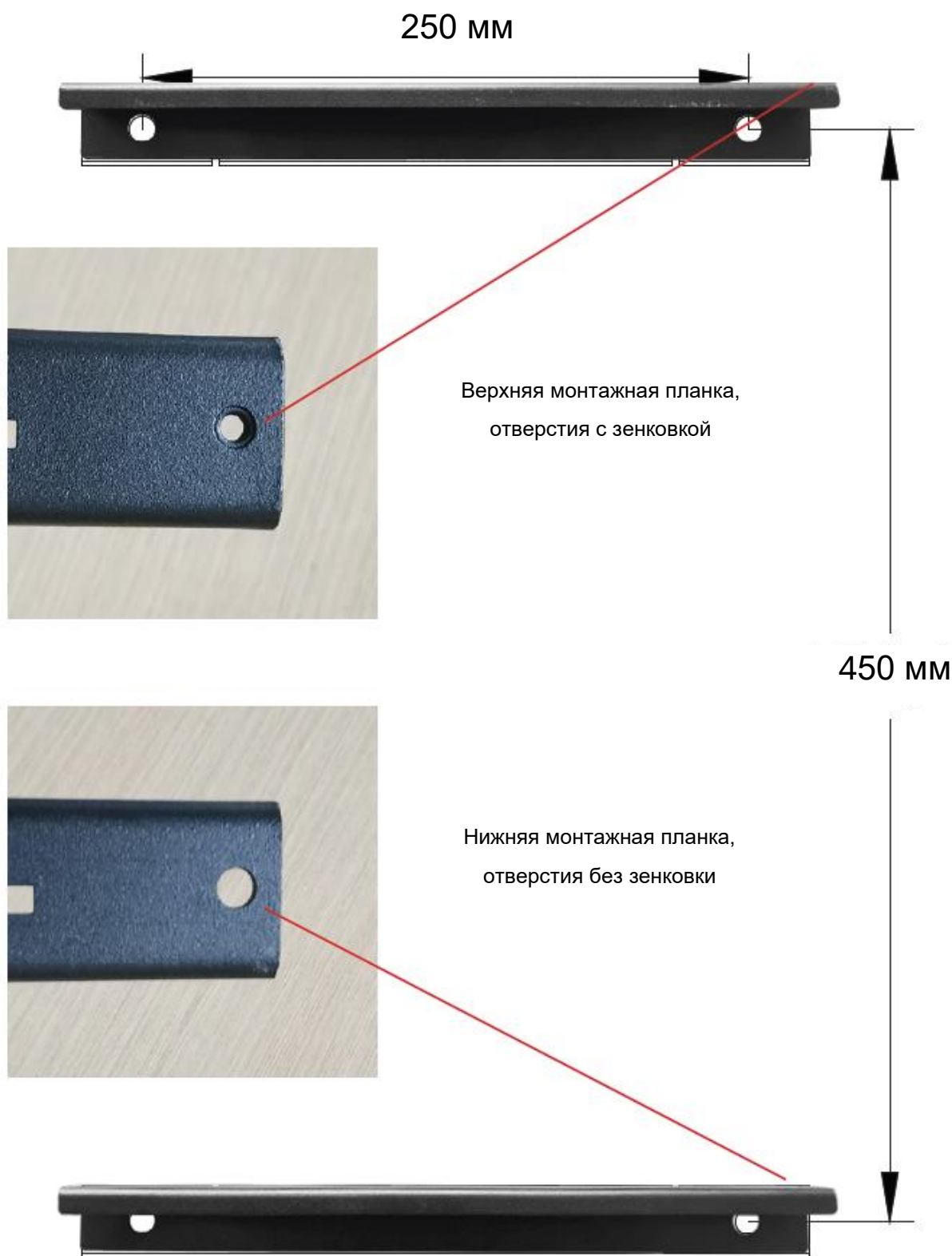
Рисунок 5. Верхняя и нижняя планка кронштейна.
