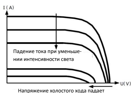
Рисунок 1-3. Зависимость выходных параметров модуля от освещенности
