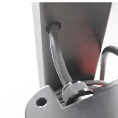
Шаг 7. Подсоедините входной кабель зарядного устройства.
