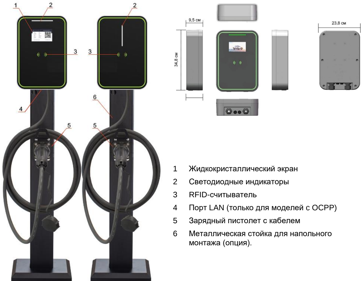
Рисунок 1. Электрозарядная станция SMARTWATT с зарядным кабелем.
