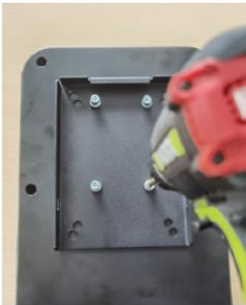
Шаг 5.2. Затяните винты с помощью ключа-шестигранника или шуруповерта с битой под шестигранник.
