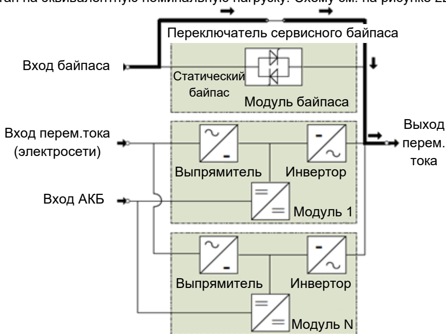
Рисунок 22. Схема работы ИБП в режиме технического обслуживания.
