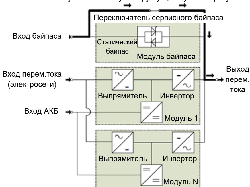
Рисунок 22. Схема работы ИБП в режиме технического обслуживания.
