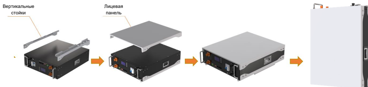
Рисунок 10. Установка креплений на накопителе.
