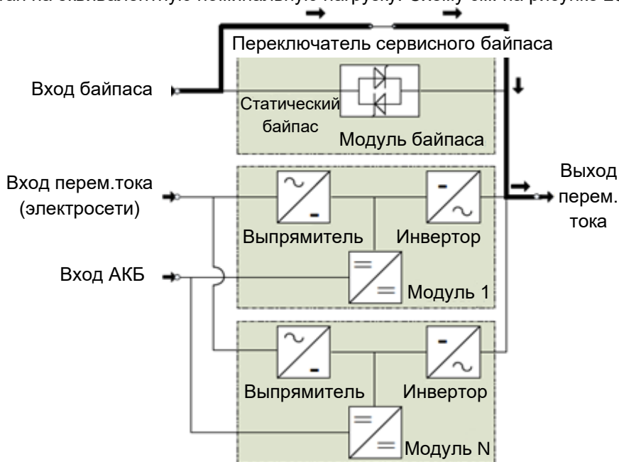
Рисунок 20. Схема работы ИБП в режиме технического обслуживания.
