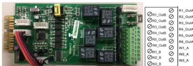
Схема назначения выводов для 18-выводной клеммы:
