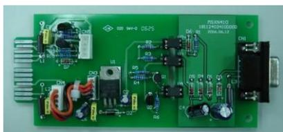
Контакт CN1 предназначен для RS232 DB9.
