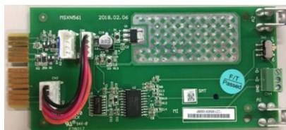
SW1 – это функция оконечного резистора. SW1 ON (ВКЛ.) активирует данную функцию, SW1 OFF (ВЫКЛ.) отключает ее (чтобы получить хорошее качество связи, нужно, чтобы при параллельном применении в активированном положении оставалось не более 2 оконечных резисторов карты RS-485).
