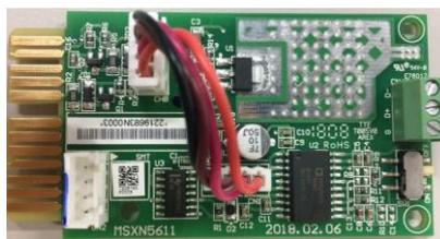
SW1 – это функция оконечного резистора. SW1 ON (ВКЛ.) активирует данную функцию, SW1 OFF (ВЫКЛ.) отключает ее (чтобы получить хорошее качество связи, нужно, чтобы при параллельном применении в активированном положении оставалось не более 2 оконечных резисторов карты RS-485). Гибкая связь от канала А (CN2) или В (CN3).
