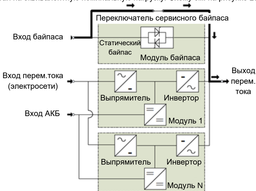
Рисунок 27. Схема работы ИБП в режиме технического обслуживания.
