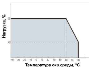
Рисунок 10. График зависимости нагрузочной способности модуля от температуры окружающей среды.
