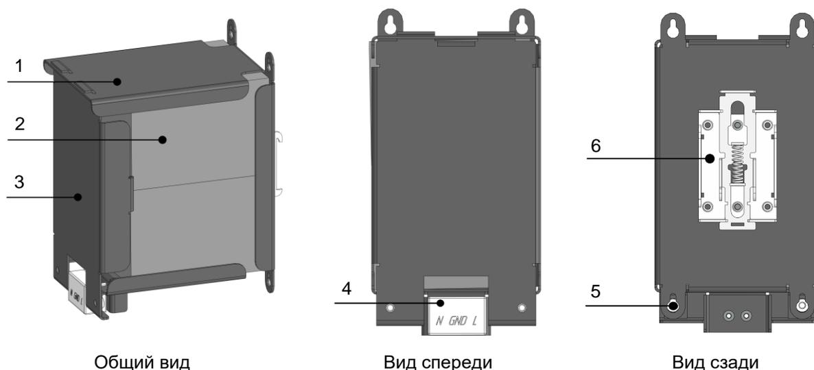
Рисунок 1. Батарейный модуль SMARTWATT PSE BAT. Наименование элементов представлено в таблице 1.
