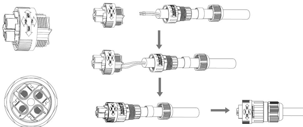
Рисунок 32. Сборка коннектора ТТ.
