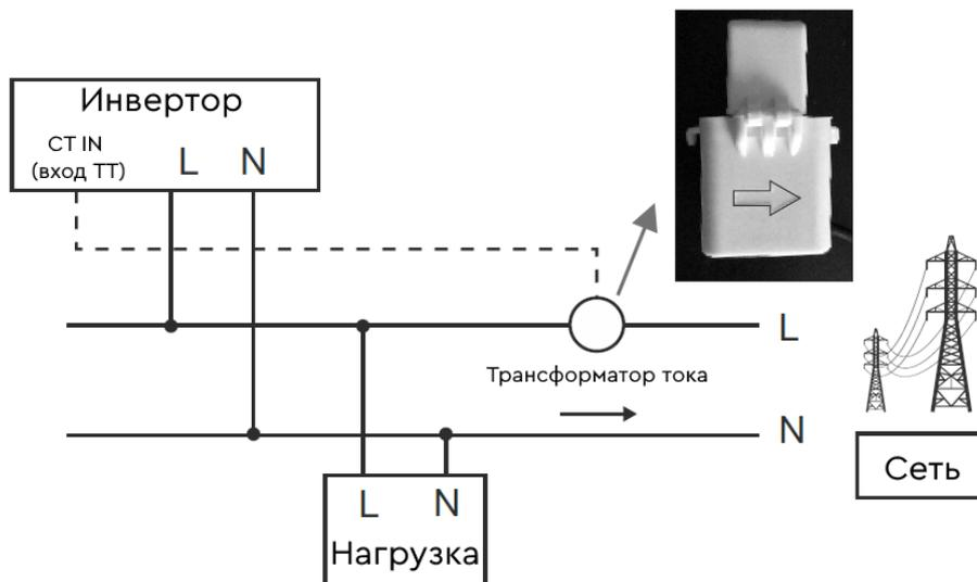
Рисунок 31. Направление трансформатора тока.
