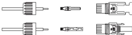
Рисунок 11. Отсоединение торцевой гайки коннектора
