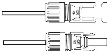
Рисунок 14. Коннектор с закрученной торцевой гайкой
