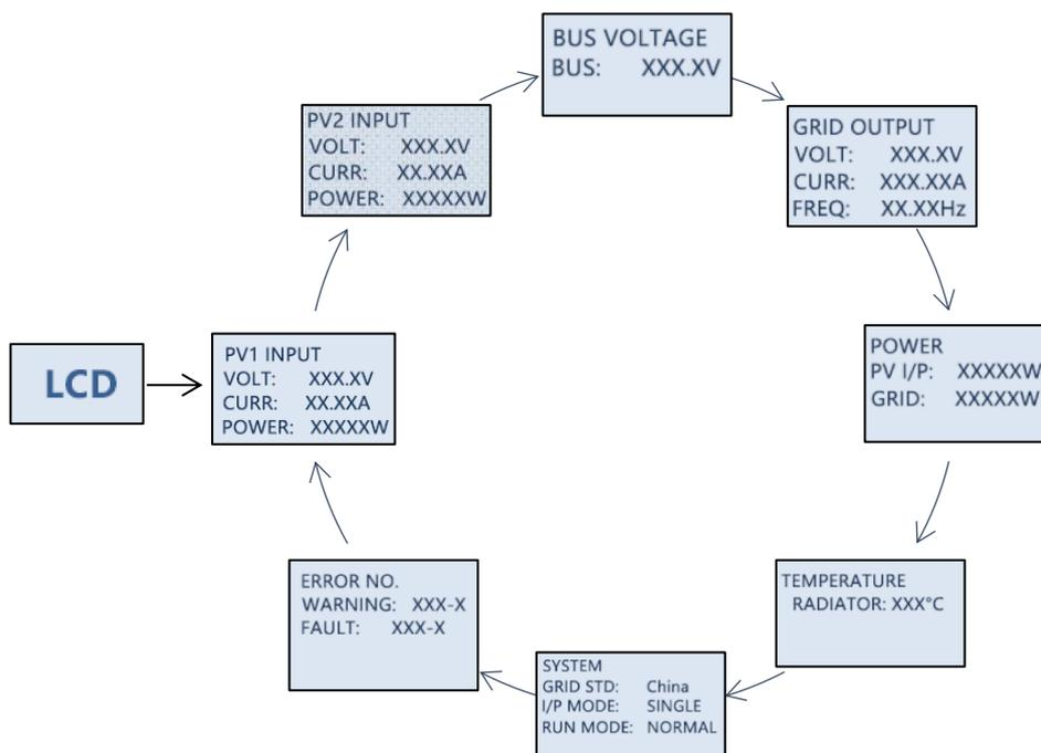
Рисунок 28. Схема меню инвертора
