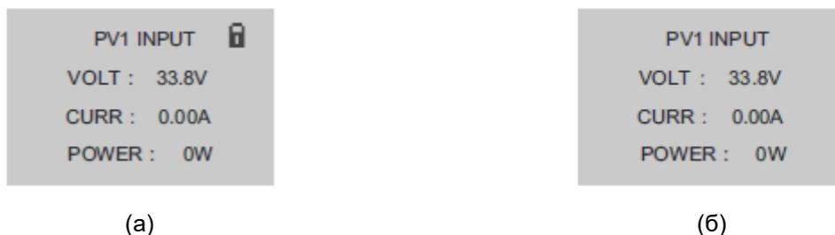
Рисунок 29. Блокировка и разблокировка ЖК-экрана инвертора
