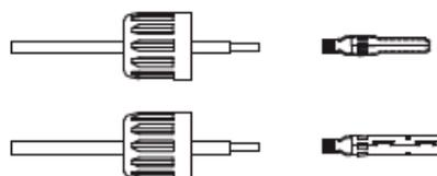
Рисунок 12. Соединение кабеля, торцевой гайки и контактного штыря
