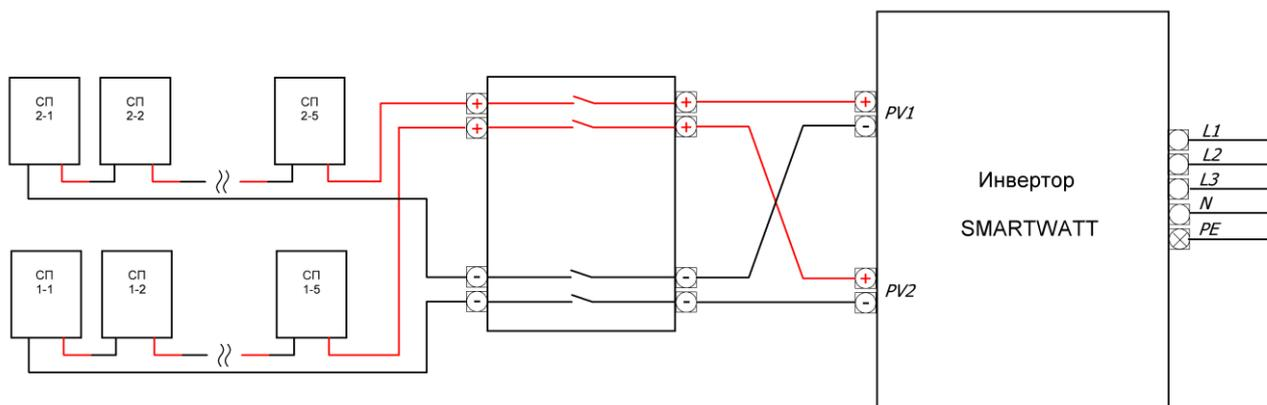
Рисунок 26. Режим независимого подключения.
