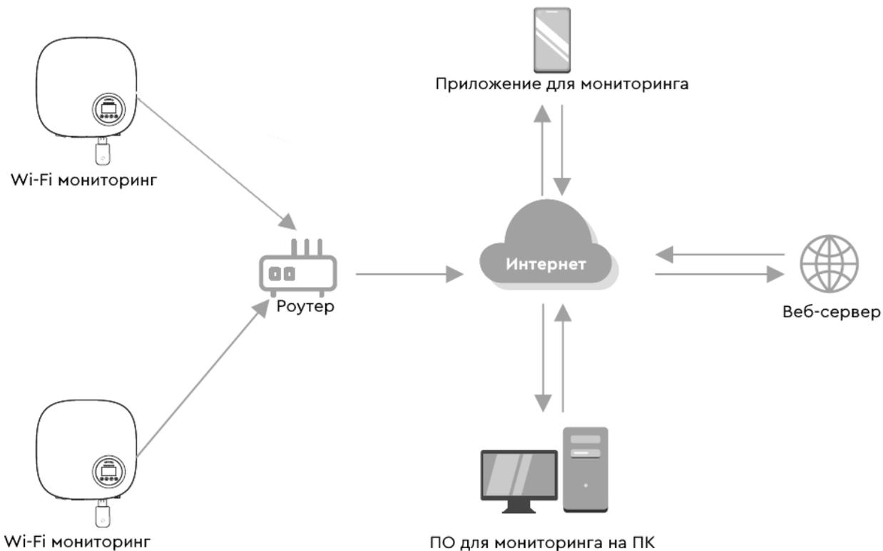
Рисунок 24. Схема системы мониторинга
